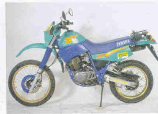
XT 600 (2KF, 1987-1990): 45 PS, 13-l-Tank, Scheibenbremse hinten, Stahlschwinge, neue Plastics. Motorschutz entfällt.
