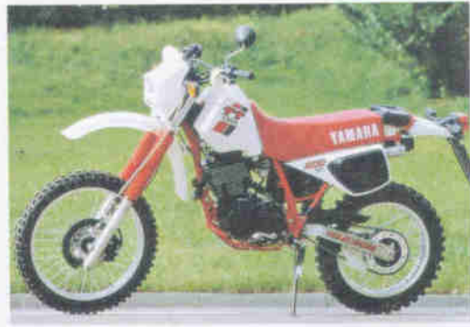
TT 600 (1983-1988): wettbewerbstaugliche Enduro mit Ténéré-Triebwerk, 44 PS, 137 kg. Mit Straßenzulassung 17 PS.
