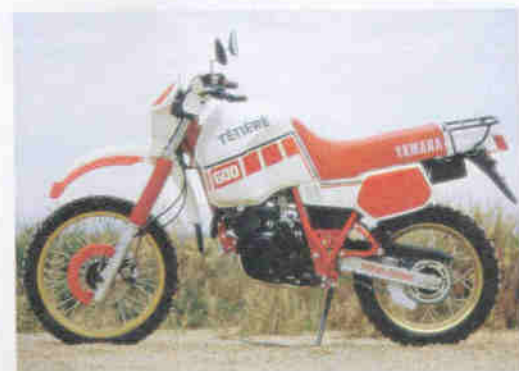
XT 600 Z Ténéré (1VI, 1986-1987): erste Ténéré mit E-Starter. 23-l-Tank, Benzinpumpe, größere Ventile, 46 PS, 175 kg.
