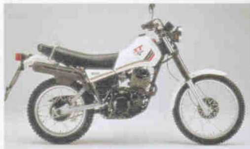
XT 550 (1982-1984): erste XT mit Vierventil-Motor. 38/27 PS, Doppelvergaser, 11,4-l-Tank, Leergewicht 145 kg.
