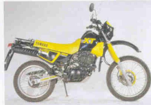
XT 350 (1985-1995): Vierventiler, 27 PS, zwei Ausgleichswellen, Doppelvergaser. 255/220 mm Federweg, 140 kg.
