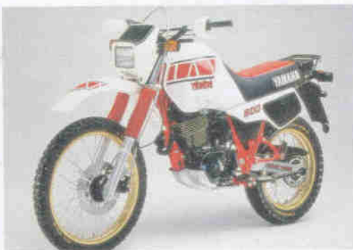
XT 600 Z Ténéré (34L, 1983-1985): aufgebohrter XT 550-Motor, 44 PS, 30-l-Tank, 930 mm Sitzh., Scheibenbremse (v.)
