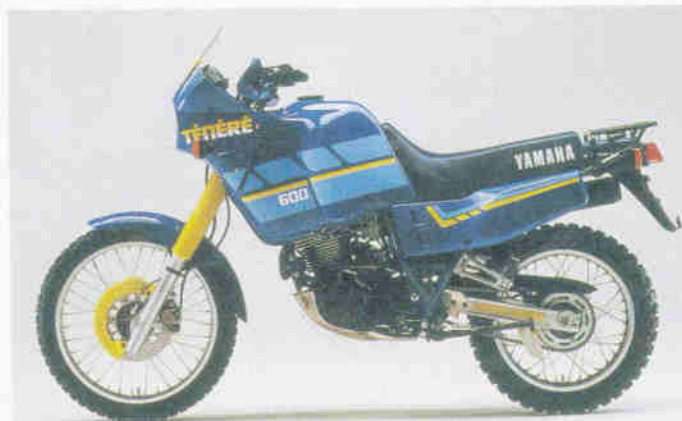
XT 600 Z Ténéré (3AJ, 1988-1990): Motor wieder standfest. Erste verkleidete XT. 23-l-Tank, Scheibenbremse hinten, 185 kg.
