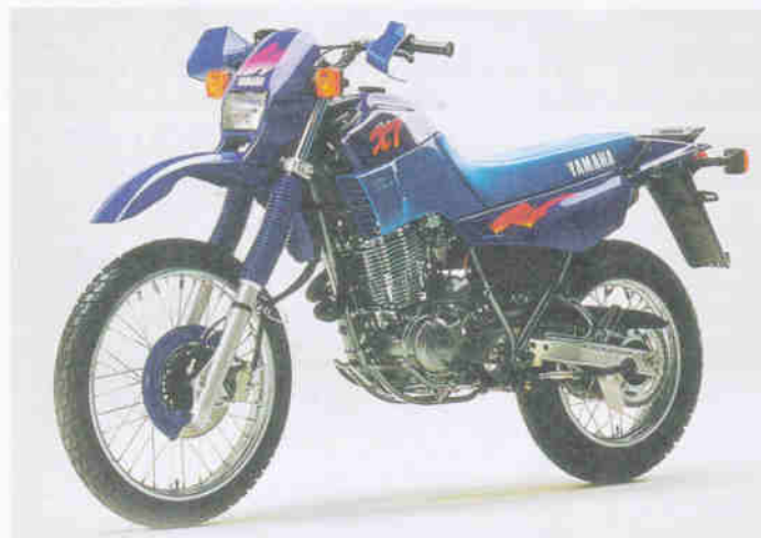
XT 600 E/K (1990-2003): neuer Rahmen, gekappte Federwege, E-Starter, Stahlfelgen, 168 kg. Drehzahlmesser entfällt.
