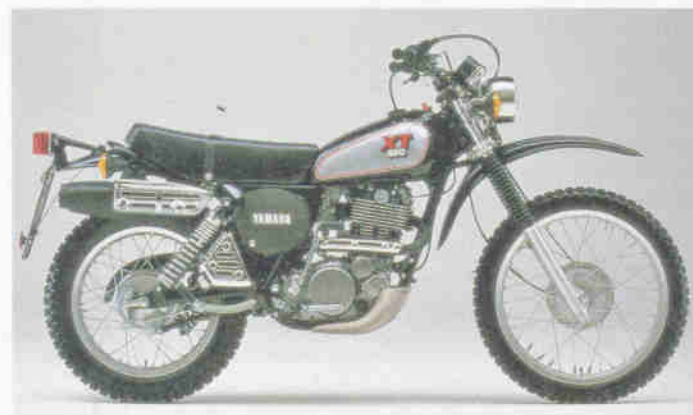
XT 500 (1976/77-1990): Zweiventil-Motor mit 27/32 PS. Trommelbremsen, 8,8-l-Tank, 150 kg Leergewicht.
