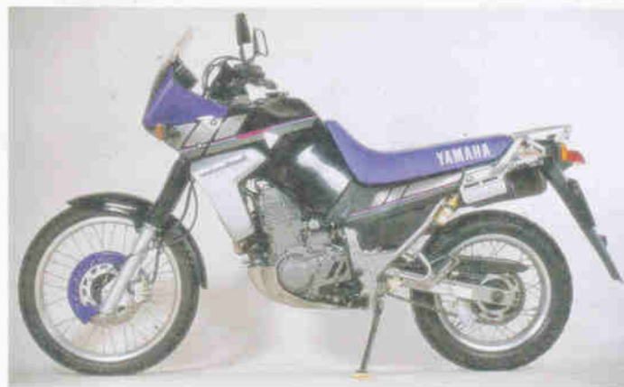
XTZ 660 Ténéré (1991-1994): erster XT-Eintopf mit Flüssigkeitskühlung und Fünfventil-Motor. 48 PS, schlanke Verkleidung.
