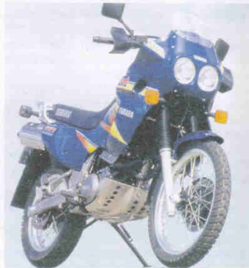
XTZ 660 Ténéré (1994-1999): bullige Doppelscheinwerfer-Verkleidung, neues Cockpit aus der XTZ 750 Super Ténéré.
