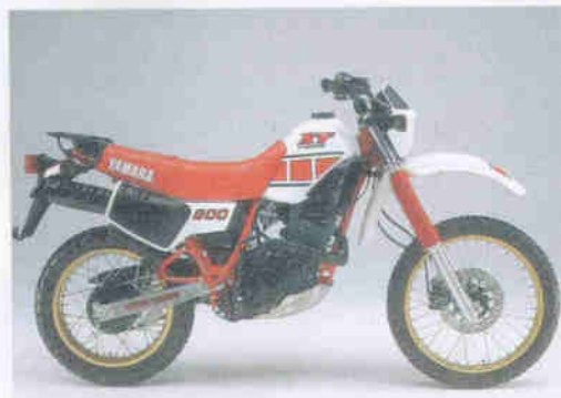
XT 600 (43F, 1984-1985): abgespeckter Ténéré-Ableger. 44 PS, 11,5-l-Tank, 153 kg, 255/235 mm Federweg.
